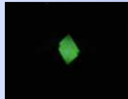
Ge:SiO 2 (*bulk) 板厚:20 μm 表面にGeを蒸着後 熱拡散によりドーピング
