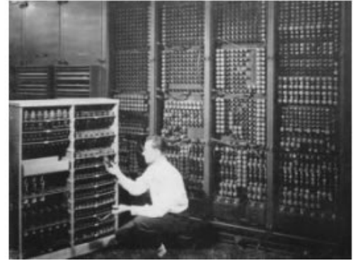
初代エニャック：真空管式コンピュータ； 床面積約60畳、重量約30トン、米軍で 弾道や原子爆弾の計算、天気予報など に活用。
